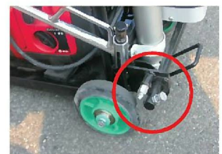
駐車ブレーキ
